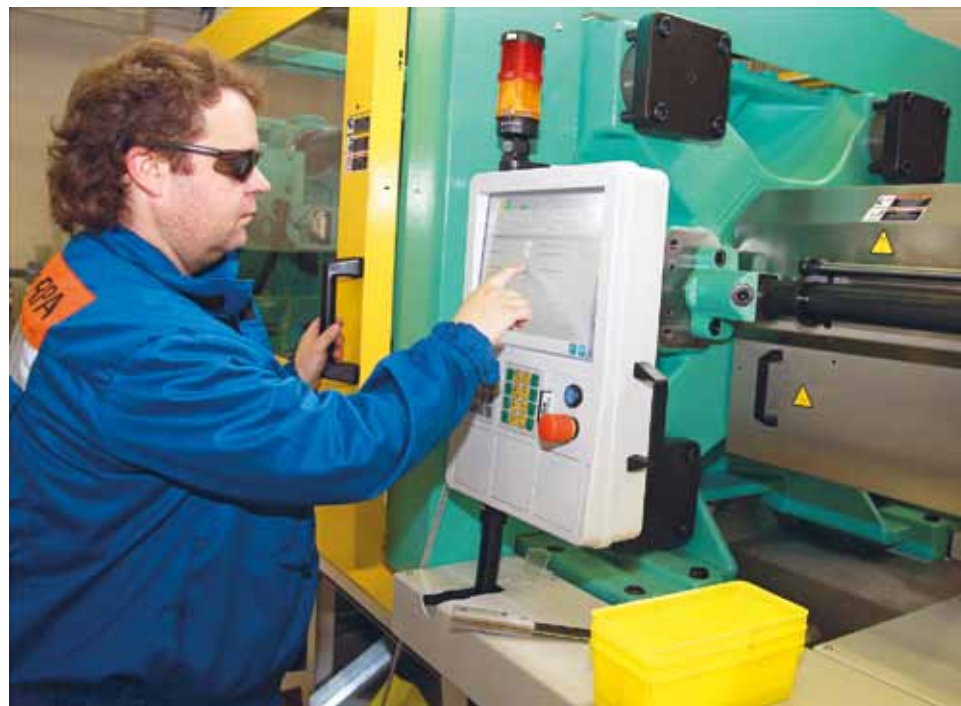
▲ Pracovník aplikační haly, Miloš Břenda, seřizuje nový vstříkací lis Arburg pro výrobu zkušebních výrobků pro kolegy z Polymer Institute Brno.
