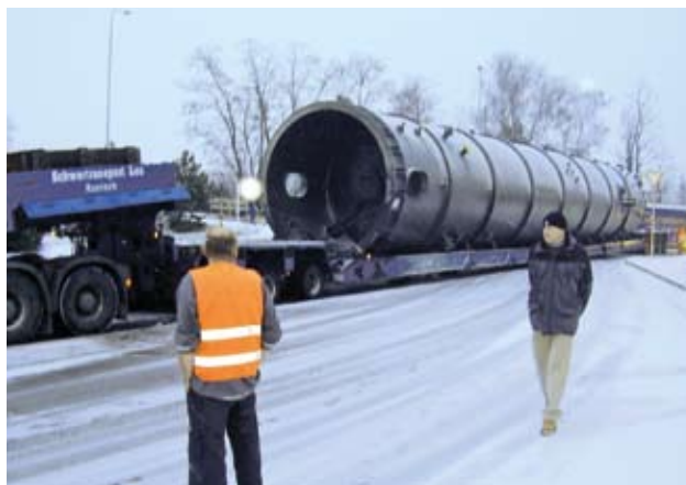
▲ Reaktor nové oxidace asfaltů o průměru 3,6 m, délce 25,35 m a o hmotnosti 58 tun rakouské firmy Pörrer dorazil do Parama 9. března 2006.
