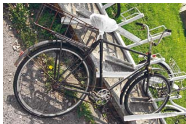
▲ Příkladem nedostatečné povinné výbavy dle vyhlášky č. 341/2002 Sb., je tato fotografie jízdního kola, na kterém zejména chybí předepsané vybavení odrazkami.
