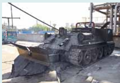
▲ Vyprošťovací tank posloužil při čištění výměníků EA 124 B a D.
