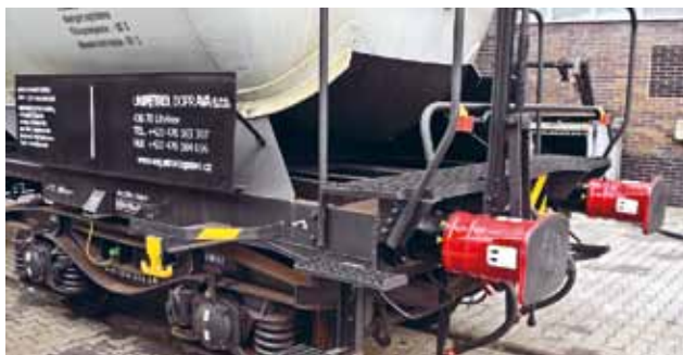
▲ Nové crash nárazníky zlepší prevenci závažných havárií při přepravě chemických látek na železnici.
